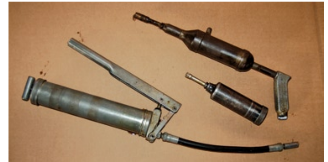
▲ Bij smeren met handbediende vetspuiten is de druk vaak veel hoger dan bij geautomatiseerde systemen en verhoogt de kans op schade aan lagers.
