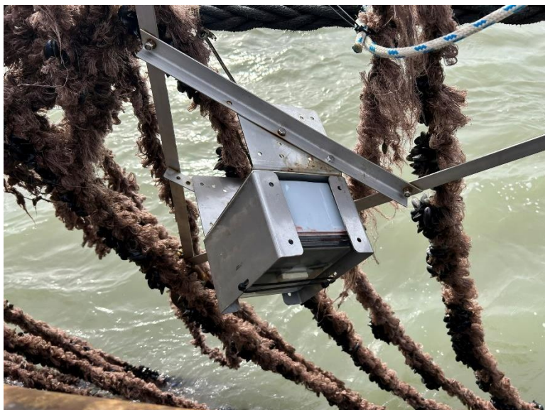
Figuur 69 Onderwater cameraframe met daarin een GoPro camera die time-lapse foto's neemt (een per uur), bevestigd tussen de mosselijnen aan de drijvende longline (LL).
