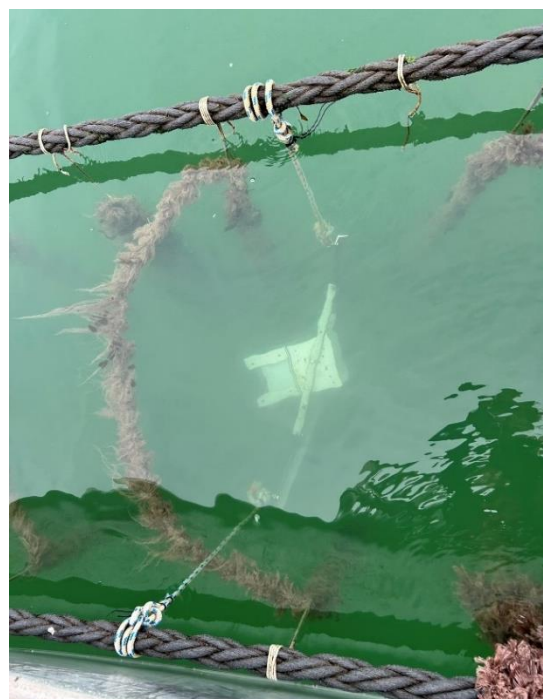
Figuur 69 Onderwater cameraframe met daarin een GoPro camera die time-lapse foto's neemt (een per uur), bevestigd tussen de mosselijnen aan de drijvende longline (LL).
