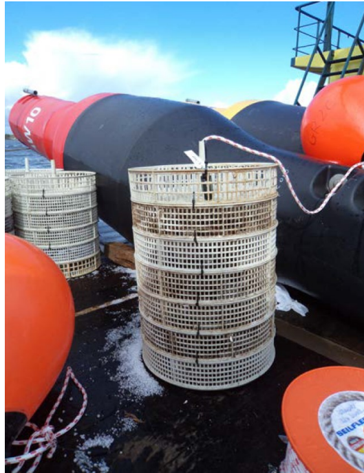
Figuur 3: Toren van mandjes gevuld met mosselen. De bovenkant van de toren hangt ongeveer 1 meter onder het wateroppervlak. Aan iedere toren is ook een geleidbaarheid- en temperatuursensor (Hobo U24-002-C) bevestigd.
