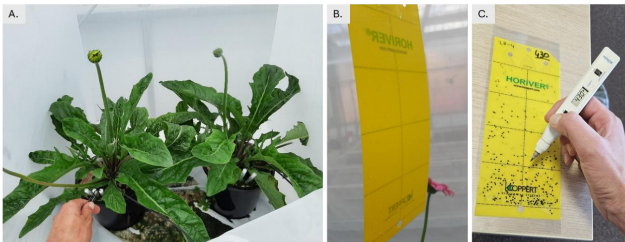
Figuur 2.5 Foto-impressie van kooiproef witte vlieg de binnen de proef Gerbera II, waarin populatieopbouw is bepaald. A. kooi met daarin twee gerbera planten waarin kaswittevlieg wordt geïntroduceerd. B. gele vangkaart in de kooien met witte vlieg. C. Tellen van wittevlieg op vangkaart uit een proefkooi m.b.v. een colony counter.
