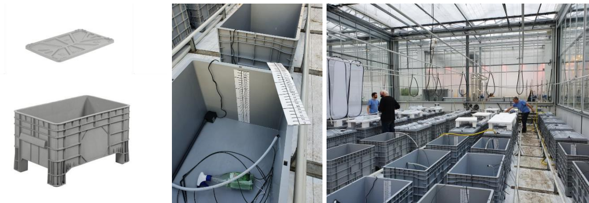
Figuur 2.1 Containers(bakken) met deksel, pompje met druppelsysteem en overzicht van plaatsing van de bakken in de kasafdeling.
