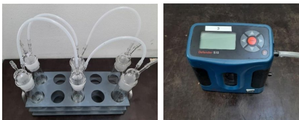
Figuur 6 Meetopstelling ammoniakmetingen. Links: Wasflessen. Rechts: Flowmeter (foto's van Groenestein et al., 2011).
