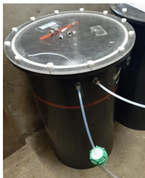
Figuur 8 Meetopstelling geurmetingen. Container met 40 liter monsternazak met aangekoppeld een Teflon leiding met een stoffilter (foto van Groenestein et al., 2011).
