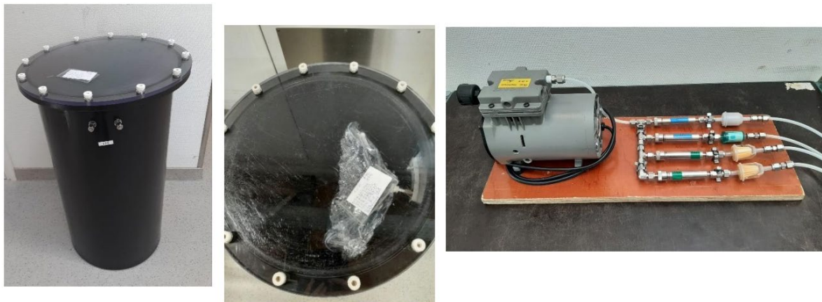
Figuur 7 Meetopstelling van de longzakmethode. Links: Container met 40 liter monsternazak. Midden: Een vacuüm getrokken 40 liter monsternazak. Rechts: pomp, monsternazakleiding en kritische openingen (foto's van Groenestein et al., 2011).
