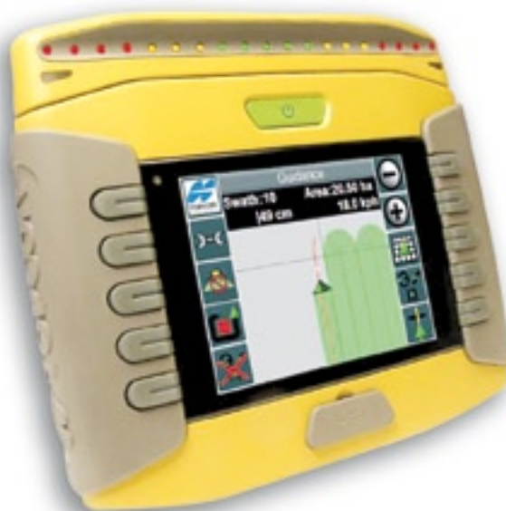
▲ Voor een nauwkeurige geleiding is een combinatie van een scherm voor het indraaien en een lichtbalk voor de lange rechte lijn het meest ideaal.
