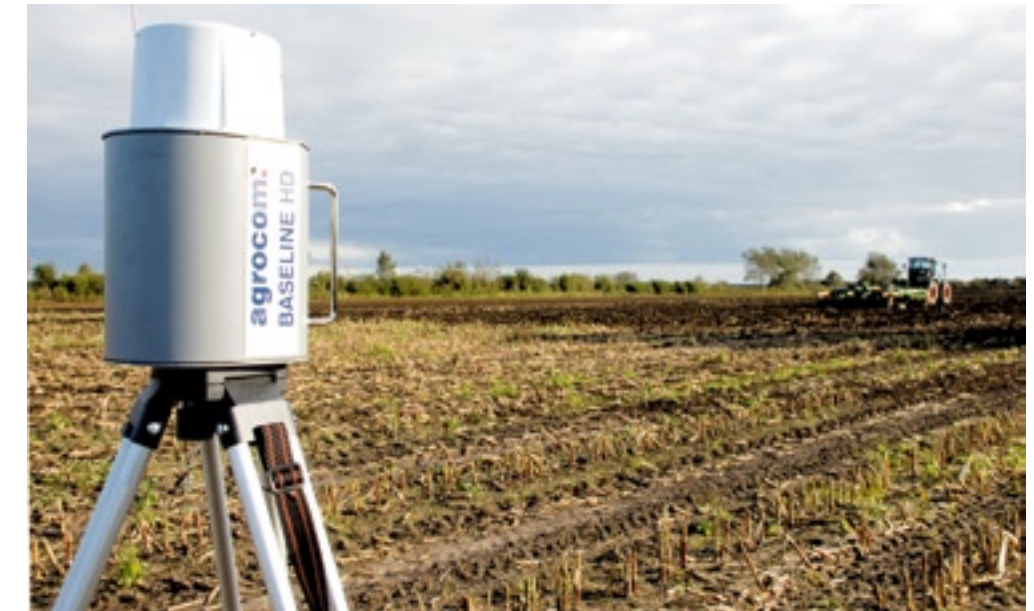
▲ Een radiografisch signaal zorgt voor een correctiesignaal bij een rtk-gps-systeem waardoor je binnen 2 cm nauwkeurig kan werken.
