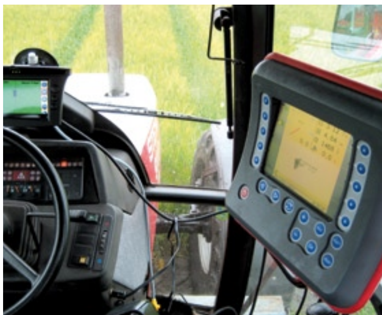
▲ Het snelheidssignaal van het gps-systeem kun je in de meeste gevallen gebruiken voor de aansturing van bijvoorbeeld een kunstmeststrooier of veldspuit.
