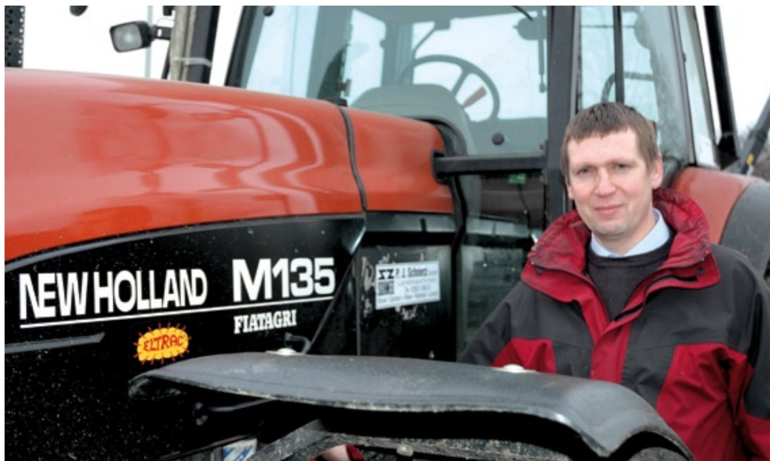
▲ Roland Schmetz van het landbouwmechanisatiebedrijf P.J. Schmetz in het Duitse Kleef ontwierp en bouwde in 1997 de diesel-elektrische Eltrac op basis van een New Holland M135. De Eltrac heeft geen mechanische verbinding tussen de motor en de wielaandrijving.
