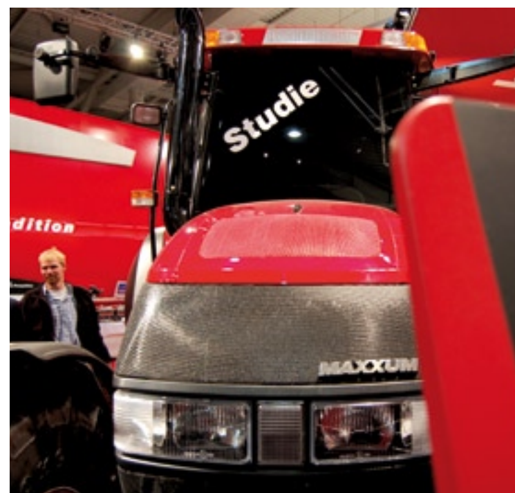
▲ EECVT was de naam van de hybride MXM 155 die Case IH toonde op de Agritechnica van 2005. Van deze trekker met z'n power-split transmissie is sindsdien niets meer vernomen.
