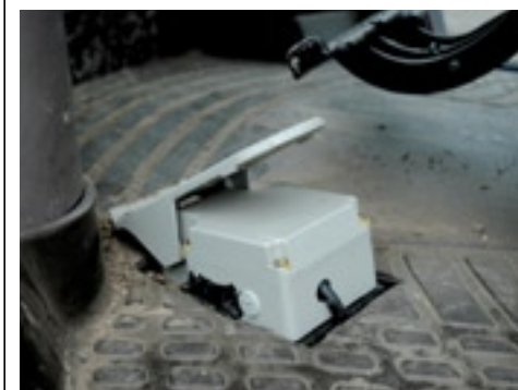
▲ De regeling van de snelheid loopt via een 'naaimachinepedaal'.
