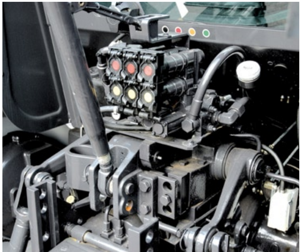
▲ De hef heeft een mechanische regeling via de topstang. De drie DW-ventielen zijn standaard. Bijzonder is de planetaire eindvertraging, die de Vision een grote bodemvrijheid kan geven.
