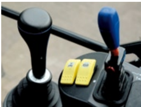
▲ Twee DW-ventielen op een kruishendel. Gele schakelaars met 4WD en differentieelslot.
