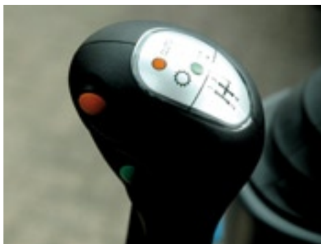
▲ De versnellingspook met knoppen voor de koppeling (rood) en hoog-laag (groen).
