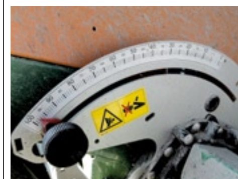
▲ De verstellenheid voor de hoeveelheidsregeling op de standaarduitvoering zit links.
