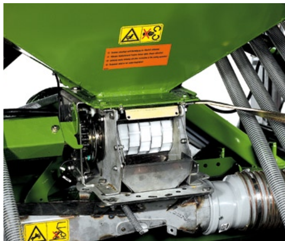
▲ De zaaddosering blijkt in de test op alle fronten goed te voldoen, bij zowel zaaien op geploegd land als in een deels bewerkte stoppel. De rol is relatief eenvoudig te vervangen.
