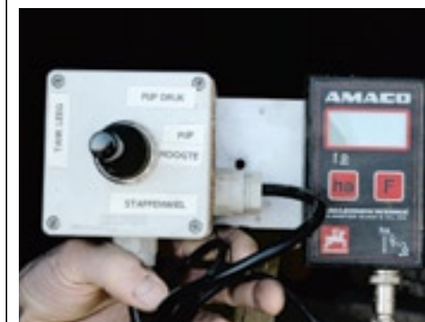
▲ De elektrische bediening voor de ventilatoren en de hectareteller van Mangnus.
