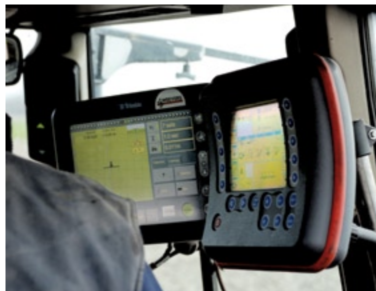
▲ De Grimme pootmachine heeft isobus-aansturing. Dit maakt het mogelijk om met een vreemde terminal te werken.
