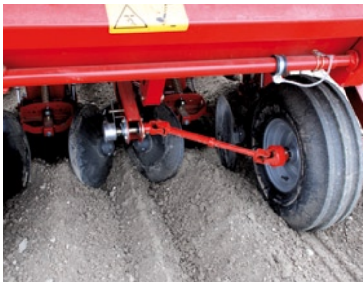
▲ De bekerpootmachine is hydraulisch aangedreven. Sensoren zorgen voor het signaal van de afgelegde weg.
