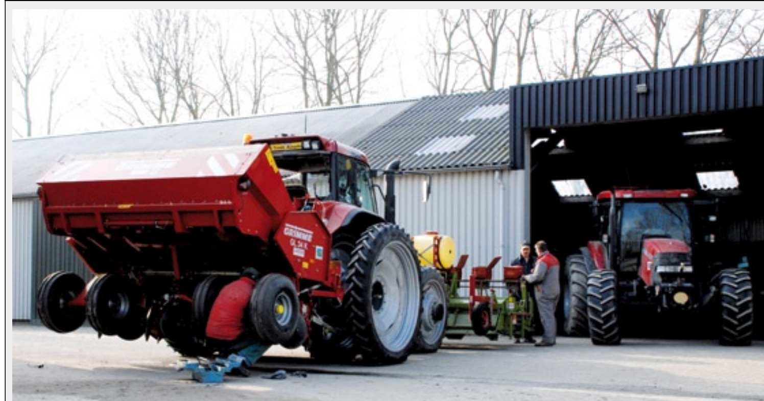
▲ De bekerpootmachine is uitgerust met een isobox voor de vertaling van de standaardcomputer van Grimme naar de isobusterminal.
