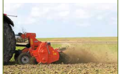
De Kuhn EL 162 BioMulch werpt het materiaal ver weg, zodat gewasresten bovenop vallen en uitdrogen.
