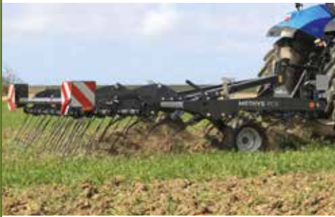
De Sky Methys PCS, een vierbalks cultivator, werkt ondiep en snijdt over de volle werkbreedte.
