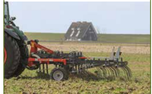
De 4Disc ActiCut met zijn tien aangedreven schijven snijdt gemakkelijk alles door.
