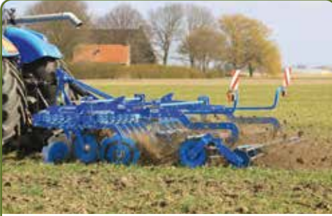
Bij de Lemken Rubin 10 zit tussen de eerste en tweede rij schijven en na de tweede rij schijven een rij veertanden voor een enigszins egaliserende werking.
