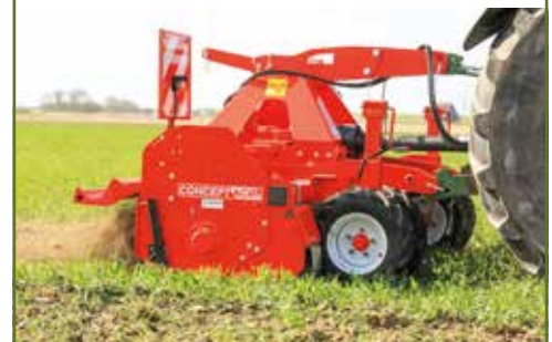
De Concept Agri SFB300 BioMulch-overtopfrees kan dankzij steunwielen voor de rotor heel ondiep werken.
