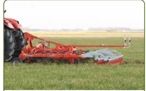
De Güttler SuperMaxx heeft zeven tandbalken en twee rijen individueel instelbare egtanden.
