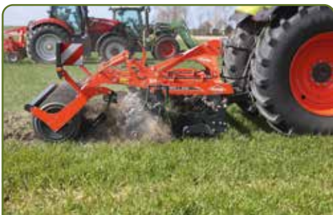
De Kuhn Optimer-schijveneg, met een werkbreedte van drie meter, is een compacte machine met individueel opgehangen schijven met een diameter van 51 centimeter.
