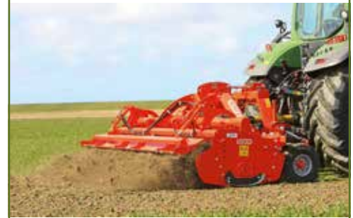
De Vigolo FPG 310 Bio werpt de afgesneden massa tegen het hydraulisch verstelbare achterbord.
