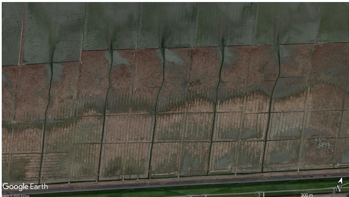
Figuur 3.4 Voormalig landaanwinningwerk waarbij het eerste bezinkveld een uitgebreid aangelegd ontwateringssysteem heeft. In het tweede bezinkveld heeft zich een natuurlijk ontwateringssysteem ontwikkeld. Door het stoppen van het greppelonderhoud zijn er in de kwelder natte plekken ontstaan.
