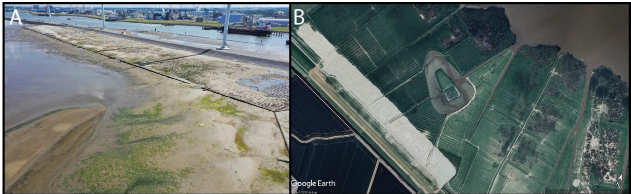
Figuur 5.1 Voorbeeld van een aangelegde kwelder (A) en herinrichting van een bestaande kwelder (B). A) Marconi kwelder is aangelegd door het wad op te hogen met zand en klei. B) Herinrichting van een kwelder in de Dollard door aanleg van een broedeiland via afgraven en ophogen. Foto A: Eemsdelta Drones.
