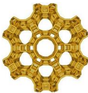
Structuur zeoliet, werkt als een zeef
