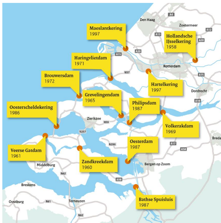
Figuur 2. Een overzicht van de deltawerken ( www.rijkswaterstaat.nl ).
