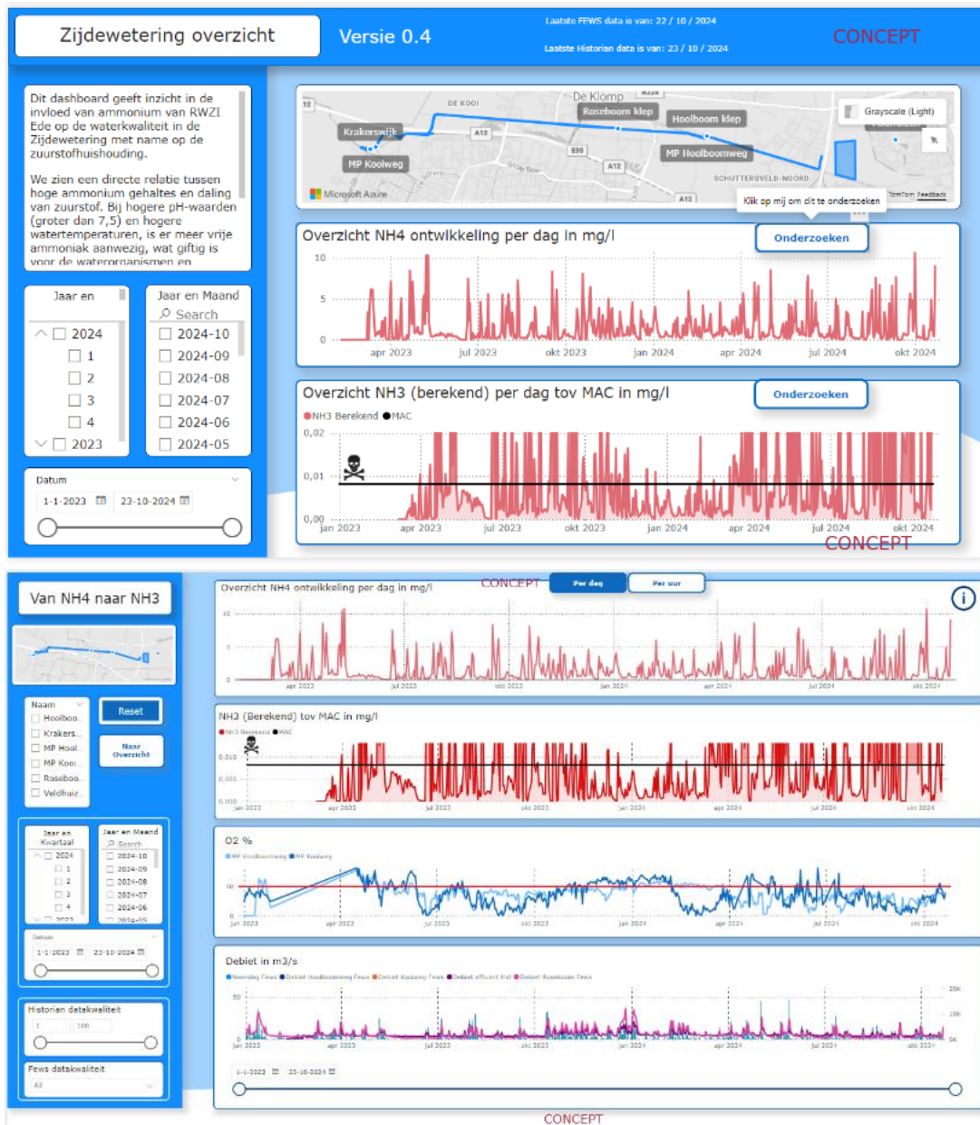
Figuur 44 Het interne dashboard Zijdewetering door Waterschap Vallei en Veluwe op basis van metingen (debiet, DO, NH 4 ) en berekeningen (NH 3 ).
