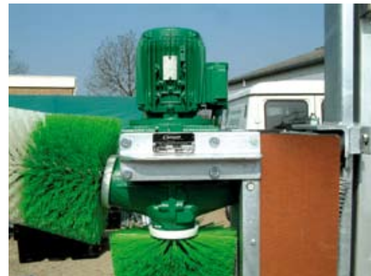
De water- en stofdichte motor is vrijwel onderhoudsvrij.
