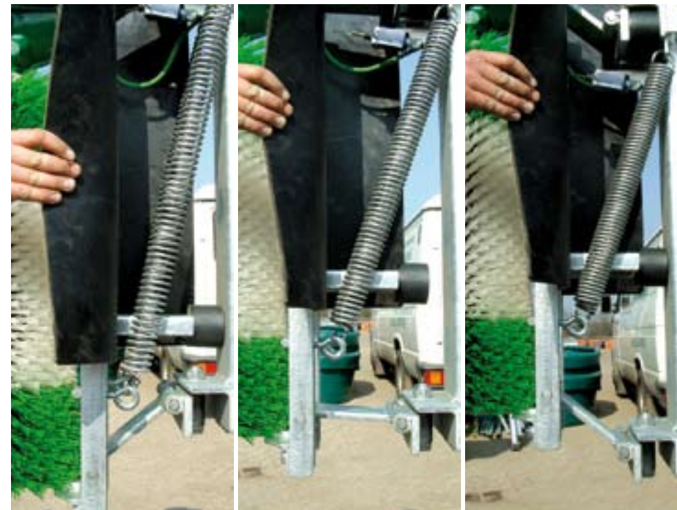
Twee veren maken het optillen van de machine licht. Verder dempen ze samen met het rubberblok de schok van de terugklappende machine.
