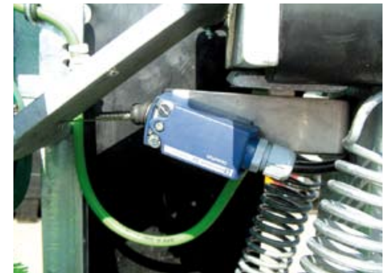
Wanneer een koe het apparaat optilt, beweegt de sensor naar boven en zet het draaimechanisme in werking.
