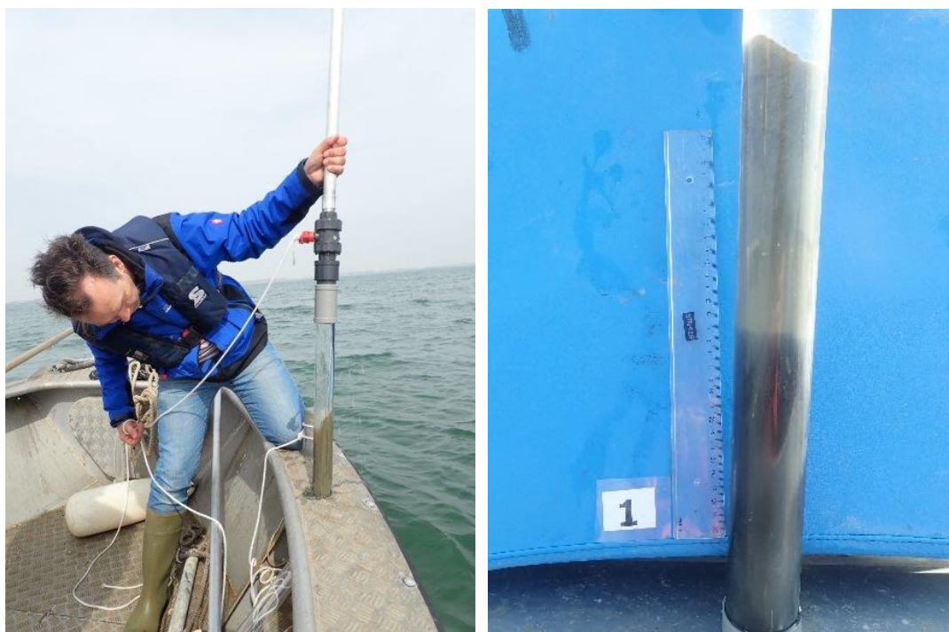
Figuur 7: Links: Monsternamen sediment samenstelling op perceel. Te zien is een deel van de aluminium buis met daaronder de perspex steekbuis. De kraan is om vacuüm in de steekbuis te behouden. Rechts: Foto van een steekbuis genomen op een perceel langs de Roggenplaat waarin de verschillende lagen zijn te zien.
