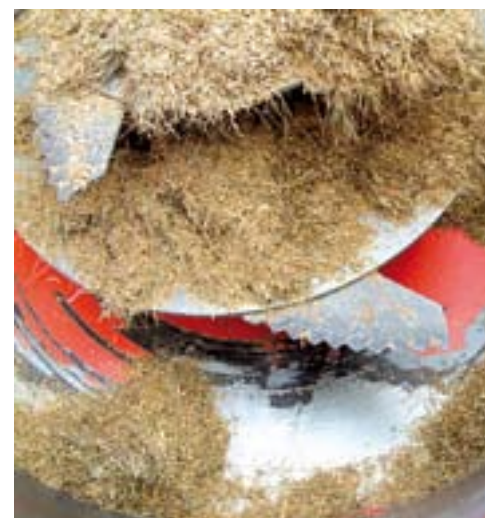
De messen van de vijzel zorgen samen met het contrames voor een goed mengresultaat.
