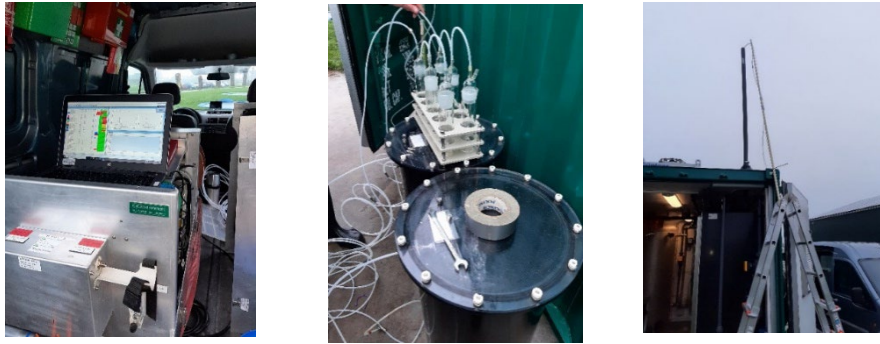
Foto 2 FTIR monitor met interface-laptop (Foto links) wasflessen (100 ml 0,05 M salpeterzuur) met de impingers erin, waarmee de \text{NH}_3 wordt opgevangen. Ter controle wordt er een tweede fles in serie geplaatst. Gesloten vaten (longmethode broeikasgassen) met 40 liter Nalophan monsternamezakken voor luchtbemonstering, monsternameleiding (teflon of polyethyleen) en kritische openingen (borosilicaatglas, binnendiameter: 8 mm; lengte: 80 mm), ondergebracht in een roestvrijstalen container voor bescherming. Lucht wordt met behulp van een pomp in de zakken in het vat gezogen (Foto midden) en uitlaat op de plasma unit met de lans voor concentratiemetingen (Foto rechts).
