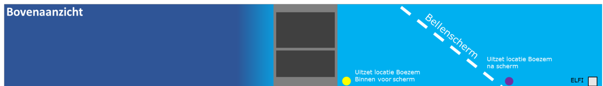
Figuur 8. Uitzet- en vangstlocaties gebruikt voor de bepaling van de passage-effectiviteit op basis van de verhouding van gemerkte glasalen die zijn voor (gele stip) en achter (paarse stip) het bellenscherm zijn losgelaten.
