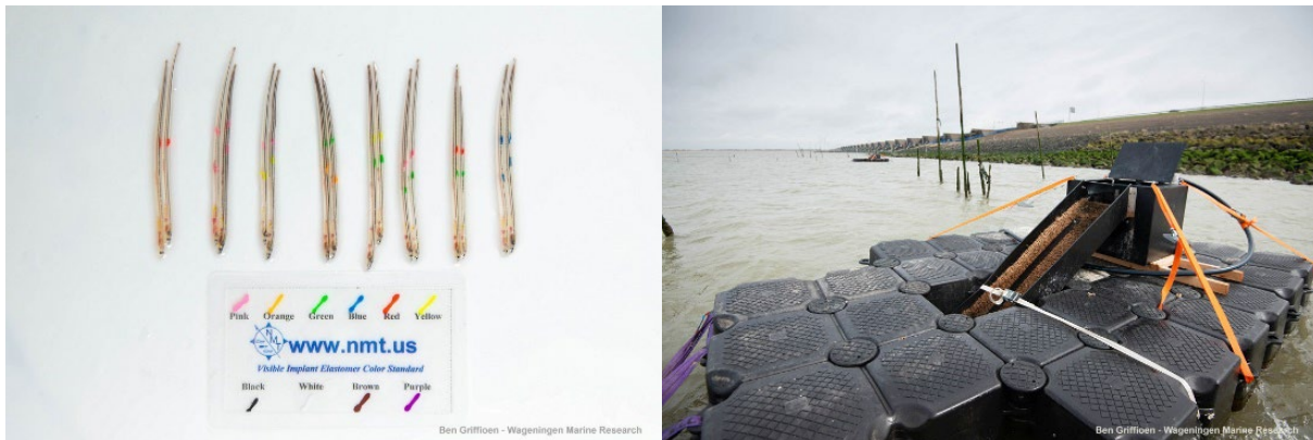
Foto 1. Foto's van gemerkte glasalen met een VIE-tag en een foto van een ELFI in dit geval geplaatst bij de Haringvlietsluizen.
