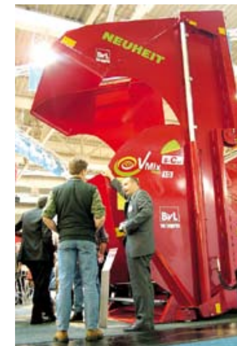
BvL heeft nu ook een zelfladende voermengwagen met stilstaand mes in het programma.
