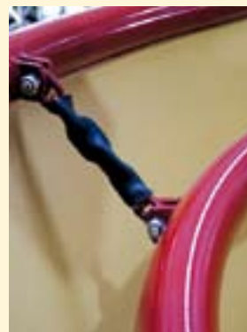
De bewegende stro-ring in de bak van een voermengwagen van BvL voorkomt dat ronde balen zich klemraaien.
