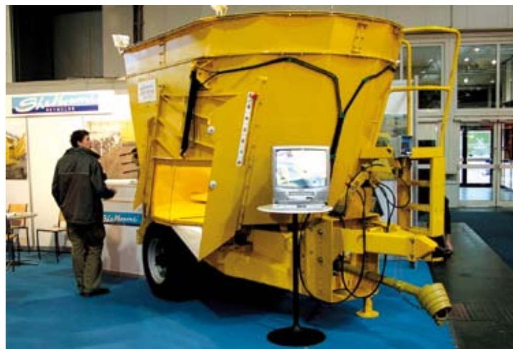
Shelbourne verplaatste de losopening waardoor het voer gemakkelijker de wagen uit gaat.
