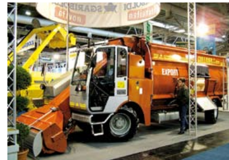
Horizontaal mengen met mengpeddels laat de structuur van het voer intact. De frees van de Sgariboldi machine maakt het voer echter wel klein.
