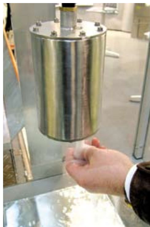
Zodra een hand onder het oog van Autowater beweegt stroomt er water uit de slang.
