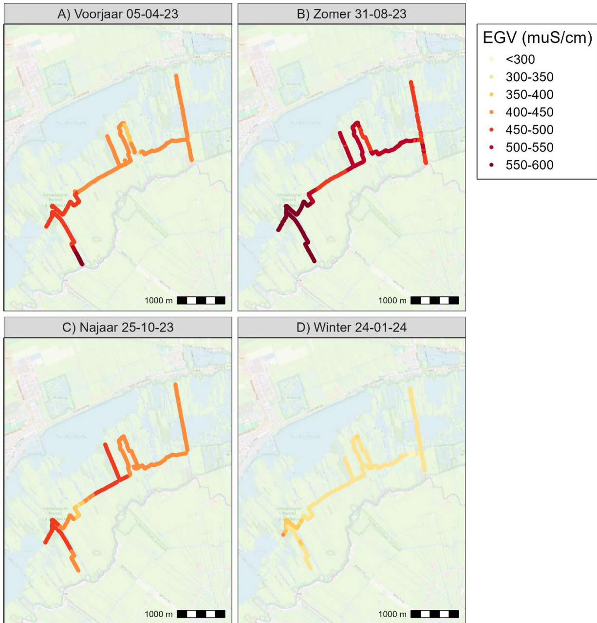
Figuur 4.14 Ruimtelijke patronen in geleidbaarheid (EGV) in het slotensysteem van de Nieuwkoopse Plassen gemeten met de Navigator-voerboot gedurende A) voorjaar 05-04-23, B) zomer 31-08-23, C) najaar 25-10-23 en D) winter 24-01-24.
