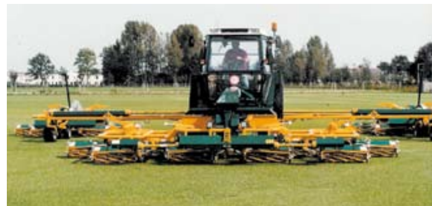
Speciaalbouw voor een graszodenbedrijf is deze brede 19-delige Kesmac kooimaaiër: een 9-delige Kesmac in de front van een Fendt trekker met twee 5-delige getrokken maaiers.
