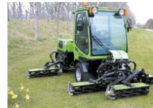
Een werktuigdrager met kooien is een alternatief voor de echte kooimaaiër als je er ook ander genoeg werk voor hebt, zoals hier de nieuwe LM-Trac 385 met vijf kooien.
