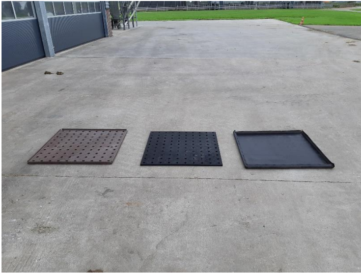
Figuur 3 Naast elkaar de drie onderdelen van de filterende tegel. Links de kunststof onderplaat met opstaande randen (gezien vanaf de bovenkant), in het midden de rubberen plaat, en rechts het filterdoek met omslaande randen (gezien vanaf de onderkant).
