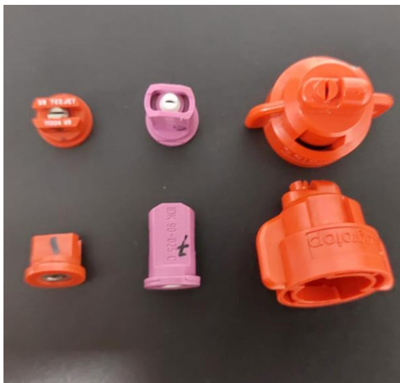
Figuur 2 De gebruikte doppen (rechts): van links naar rechts de TeeJet XR 110 04, de Lechler IDK 90 025C en de Agrotop SoftDrop 110 04.
