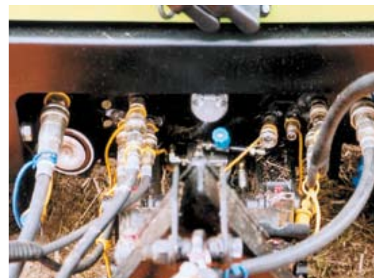
Standaard is de machine hydraulisch heel compleet uitgerust: inclusief hydromotoraansluiting op loadsensing en automatische borstedrukregeling op de fronthead.
