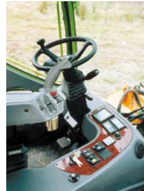
De grote hendel op de armleuning bedient de fronthead die proportioneel werkt. Ondanks het grote aantal hydraulische en elektrische functies blijven de bedieningspanelen eenvoudig en overzichtelijk. De cabine is netjes afgewerkt.
