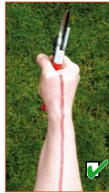
Goede houding hand, foute houding snoeischaar. Als je de gewone snoeischaar vasthoudt met de hand in de natuurlijke houding, staat de snoeischaar 15 graden scheef op de arm.
