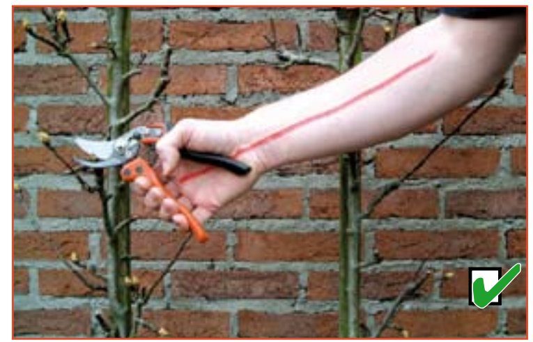
Doordat het mes van de ergonomische snoeischaar al naar voren is gebogen, hoeft de hand niet naar beneden te buigen. De pezen lopen nu netjes recht door. De kracht wordt gelijkmatig verdeeld over de pezen, peesscheden en gewrichtsbanden.
