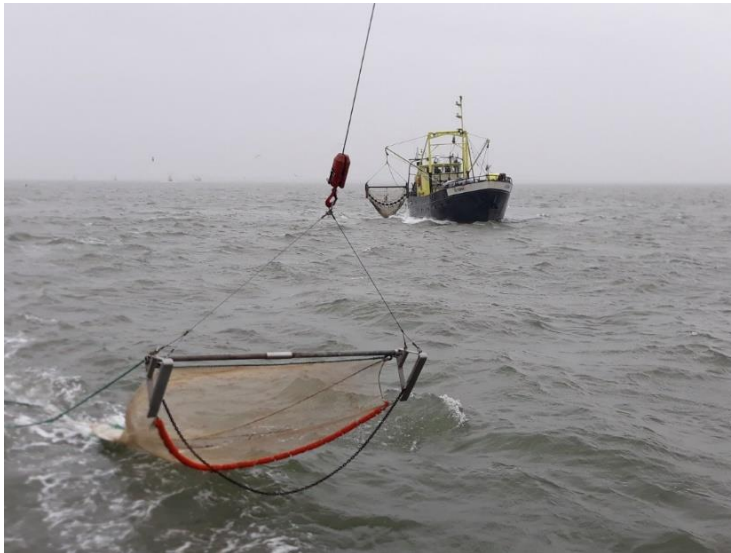
Figuur 2.2 Vergelijkend vissen met linksvoor het Krukeltuig en rechtsachter de Stern met het DFS-tuig.
