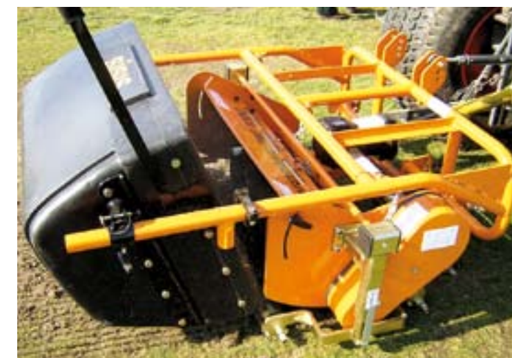
De nieuwe Sisis TM 1000 is een eendelige verticuteerder met opvangbak voor in de driepunt van een trekker. De rotor heeft standaard 2 mm dikke messen met harde widdiapunten. De onderlinge mesafstand is variabel in te stellen. De werkdiepte kan je instellen met de spindel van de steunrol en is maximale 50 mm.
