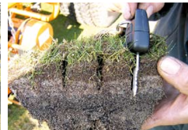
De nieuwe Sisis TM 1000 is een eendelige verticuteerder met opvangbak voor in de driepunt van een trekker. De rotor heeft standaard 2 mm dikke messen met harde widdiapunten. De onderlinge mesafstand is variabel in te stellen. De werkdiepte kan je instellen met de spindel van de steunrol en is maximale 50 mm.
