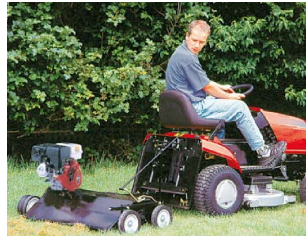
De Tielbürger TV900 is een kleine getrokken verticuteermachine met eigen motor voor achter een zitmaaier of compacttrekker. Deze heeft V-snaaraandrijving, stalen gelagerde wielen en een gelagerde rotoras.
