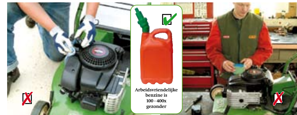
Het gevaar van vergiftiging bij tuin- en parkmachines wordt onderschat. Huidcontact met normale ongelode benzine en inademen van de dampen geven veel grotere gezondheidsrisico's dan arbeidsvriendelijke benzine.
