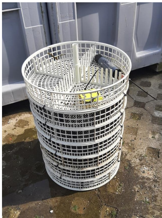
Figuur 2: Toren van mandjes gevuld met mosselen. Bovenop de toren is de zuurstofsensor zichtbaar.
