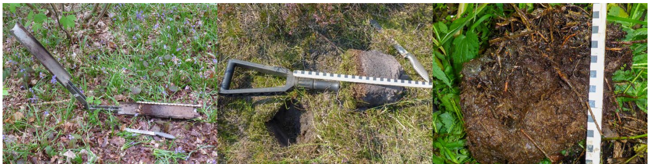
Figuur 3.4 Het steken van een humusprofiel met een humushapper (links), schep (midden) en mes (rechts).
