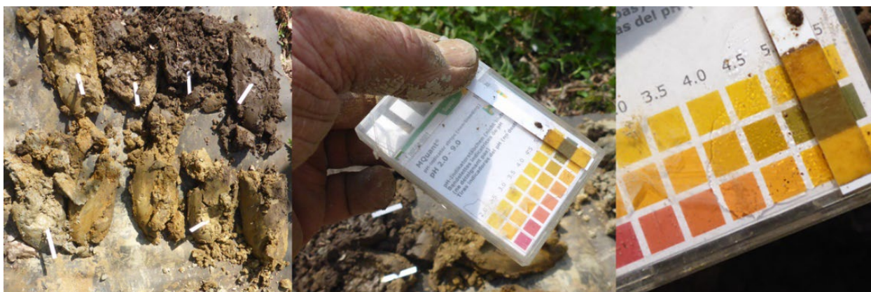
Figuur 6.1 Veldbepaling van pH met indicatorstrookjes. Deze worden in de grond gestoken waarna de grond nat gemaakt wordt met demi-water. Na enige tijd kan de pH worden afgelezen aan de verkleuring. De schaal kent stappen van een halve pH-eenheid. Tussentijdse waarden kunnen op 0,1 eenheid geschat worden. De gebruikte strookjes hebben een bereik van pH = 2,0 tot 9,0.
