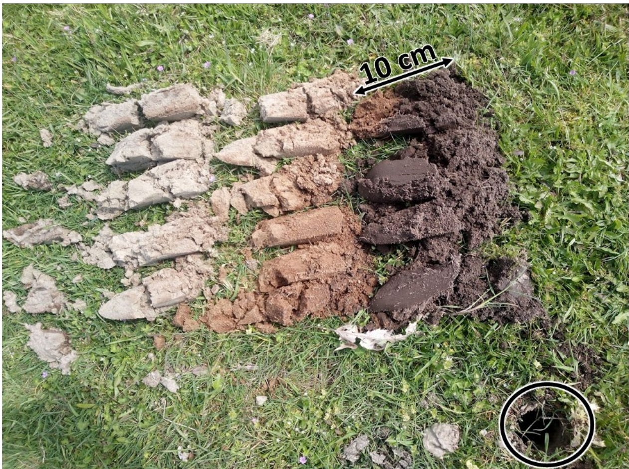
Figuur 3.1 Uitgelegde grond bij een bodemkundige boring. Elk monster is maximaal 10 cm hoog. Het bodemmateriaal wordt per 40 cm diepte naast elkaar gelegd. In deze foto ligt het bodemmateriaal van 0-40 cm-mv rechts, van 40-80 cm-mv in het midden en van 80-120 cm-mv aan de linkerkant van de foto. Het boorgat is rechts onderin te zien. Foto: Kees Teuling.
