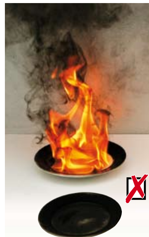
De brandende schoteltest. Gewone Euro 95 bevat veel zware brandstof componenten die slecht verbranden en veel roetvorming (koolafzetting) geven. Arbeidsvriendelijke alkylaatbenzine verbrandt goed, vrijwel zonder roetvorming.
