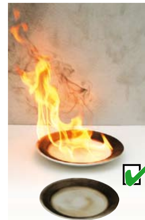
De brandende schoteltest. Gewone Euro 95 bevat veel zware brandstof componenten die slecht verbranden en veel roetvorming (koolafzetting) geven. Arbeidsvriendelijke alkylaatbenzine verbrandt goed, vrijwel zonder roetvorming.
