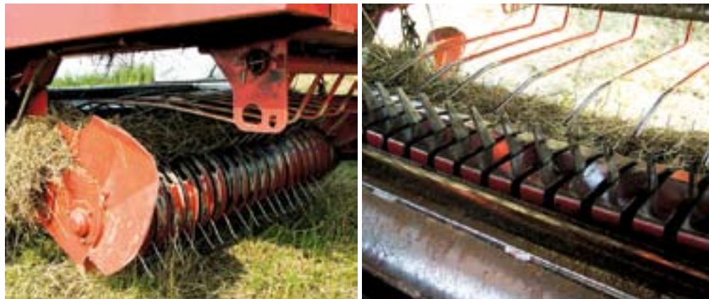
Bermenpersers hebben een 'haat-liefde' verhouding met een invoerhark achter de opraper. In tamelijk droog materiaal verhoogt die de invoercapaciteit, in heel nat en zwaar spul zoals sloopvuil kan een invoerhark de capaciteit juist beperken.
