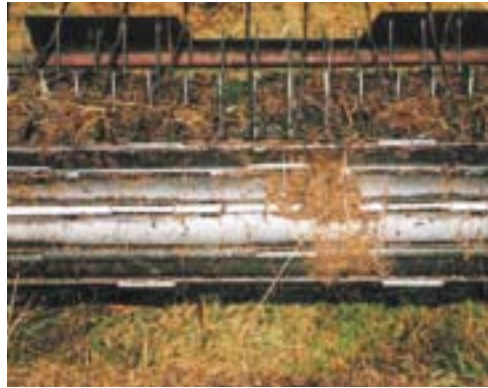
Een typische aanpassing voor bermenwerk zijn extra opgelaste strippen op de eerste rol achter de opraper. Die maakt de rol wat agressiever voor betere invoer van erg nat en zwaar materiaal.
