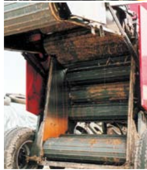
Een Vicon rollenpers voldoet prima in het bermenwerk. Een minpuntje van een rollensysteem is dat onder zeer natte omstandigheden gras aan de rollen blijft plakken. Onder extreme omstandigheden houdt een kettingsysteem het dan vaak wat langer vol.
