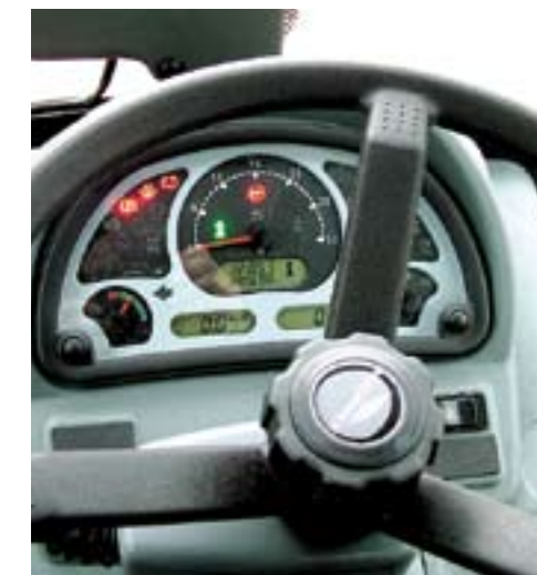
Het bedieningspaneel biedt heldere informatie op drie digitale tellers, die snelheid, aftakstoerental, tijd, bewerkte hectares, afgelegde kilometers en urenstand aangeven. De analoge teller laat het motor-toerental zien.
