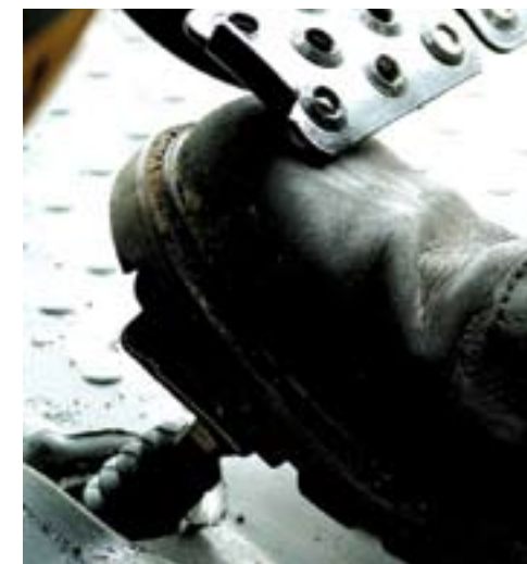
Het gaspedaal van de CX85L zit op een onbegrijpelijke plaats. Tijdens het loslaten van het gas zit je voet klem tussen dat pedaal en de pedalen van de remmen. Trap je, bijvoorbeeld tijdens een noodstop, de rem in, dan is de kans groot dat tegelijkertijd het gaspedaal wordt bediend.
