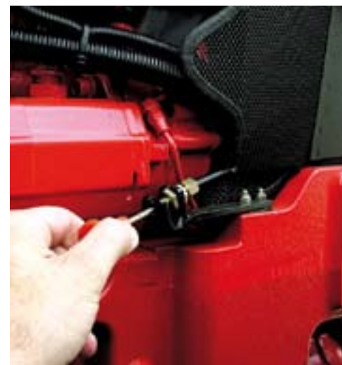
Het openen van de bij de cabine scharnierende motorkap gaat gemakkelijk met een koordje aan de rechterkant van de trekker.
