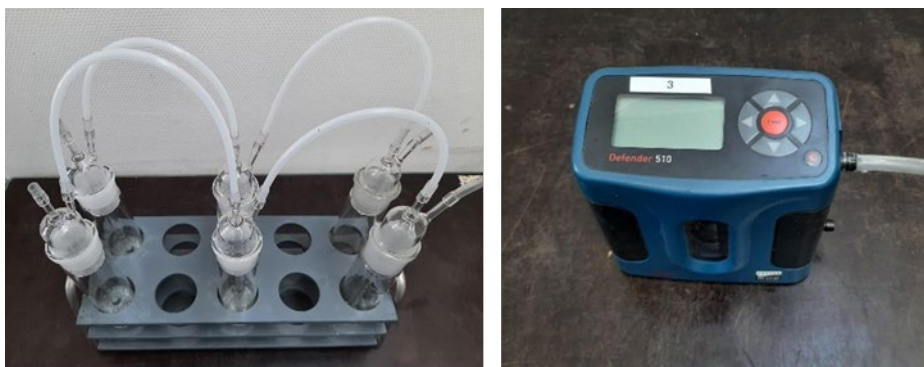
Figuur 11 Meetopstelling voor ammoniakmetingen. Links: wasflessen. Rechts: flowmeter.
