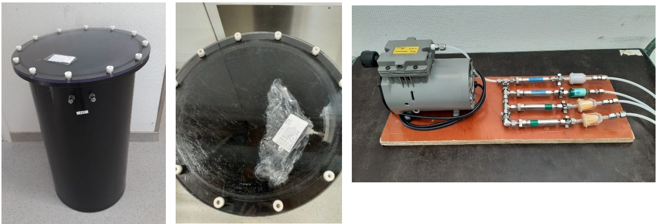
Figuur 12 Meetopstelling voor de methaan metingen. Links: container met 40 liter monsternamezak. Midden: een 40 liter monsternamezak onder vacuüm. Rechts: pomp, monsternameleiding en kritische openingen, geplaatst in een roestvrijstalen houder voor bescherming).
