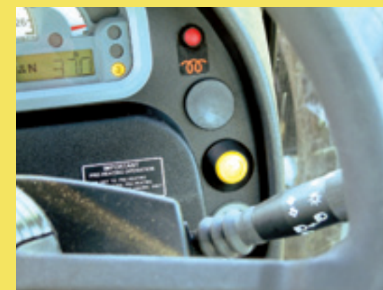
Alleen de gele knop in het dashboard 'verraadt' dat er op deze trekker Stop and Go zit.
