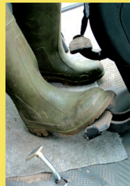
Als Stop and Go wordt ingeschakeld, dient de rem tegelijk als koppeling. Bij manoeuvreerwerk zoals met de voorlader of bij het aankoppelen van een werktuig, hoeft de chauffeur dus niet meer zowel de koppeling als de rem in te trappen.
