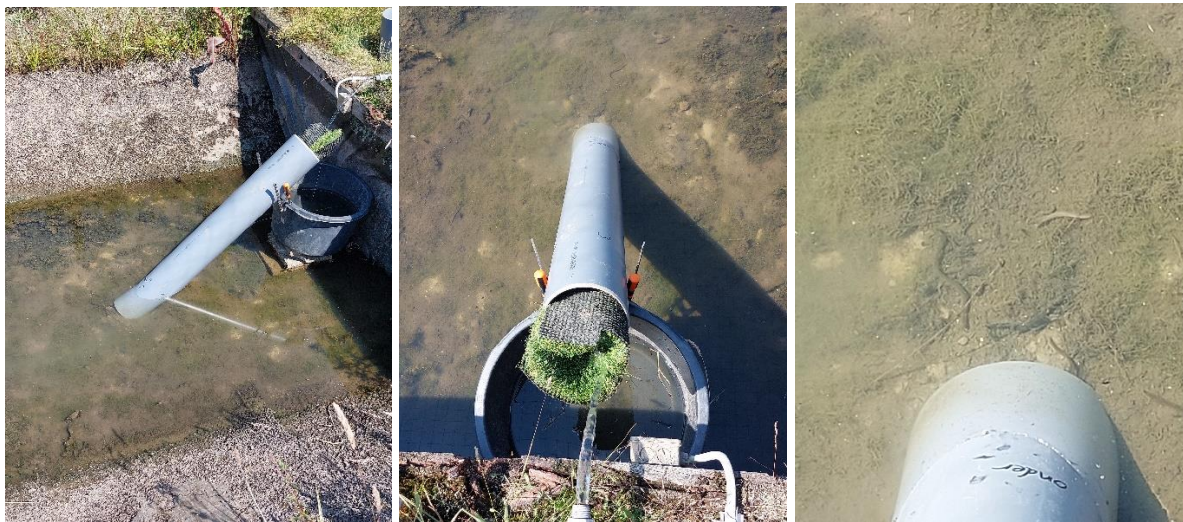
Figuur 13 Tijdens het opruimen van de proeven met de pootaal werd de uittreedbuis bekleed met kunstgras aan de kopse kant van de sloot geplaatst en werd er een lokstroom door de buis geleid. De pootaal wist dit direct te vinden en kroop via de buis de opvangcontainer in. Foto's: Ivo Roessink®.
