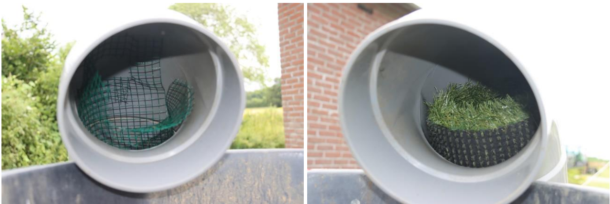
Figuur 8 Bij het testen van de uitloop van kreeften is gaas met een maaswijdte van 12 mm en kunstgras met een lengte van 38 mm als bekleding van de buis gebruikt. Foto's: Fabrice Ottburg®.
