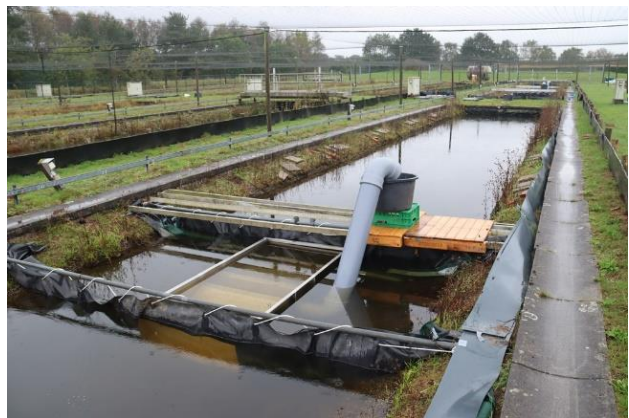
Figuur 4 Schematische weergave en foto's van de proefopstelling. De zwarte balk geeft de kreeftensleuf weer en de blauwe vlakken de schermen die geplaatst zijn zodat er geen migratie om de sleuf heen mogelijk was. Alle test organismen werden dus gedwongen om over de sleuf heen te bewegen. De uittreedbuis kwam uit in een opvangbak waarin een laagje water met beluchting aanwezig was. Foto's: Fabrice Ottburg©.
