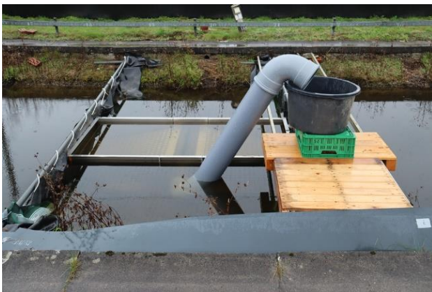
Figuur 4 Schematische weergave en foto's van de proefopstelling. De zwarte balk geeft de kreeftensleuf weer en de blauwe vlakken de schermen die geplaatst zijn zodat er geen migratie om de sleuf heen mogelijk was. Alle test organismen werden dus gedwongen om over de sleuf heen te bewegen. De uittreedbuis kwam uit in een opvangbak waarin een laagje water met beluchting aanwezig was. Foto's: Fabrice Ottburg©.
