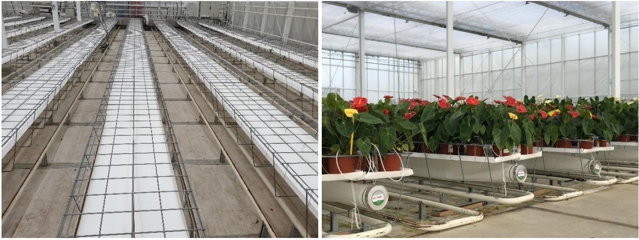
Figuur 2 Het teeltsysteem zoals uitgevoerd. Links detail rastersysteem met draingoot onder rustend op de railbuis. Rechts met de luchtslangen onder de goot en het gewas kort na het planten.
