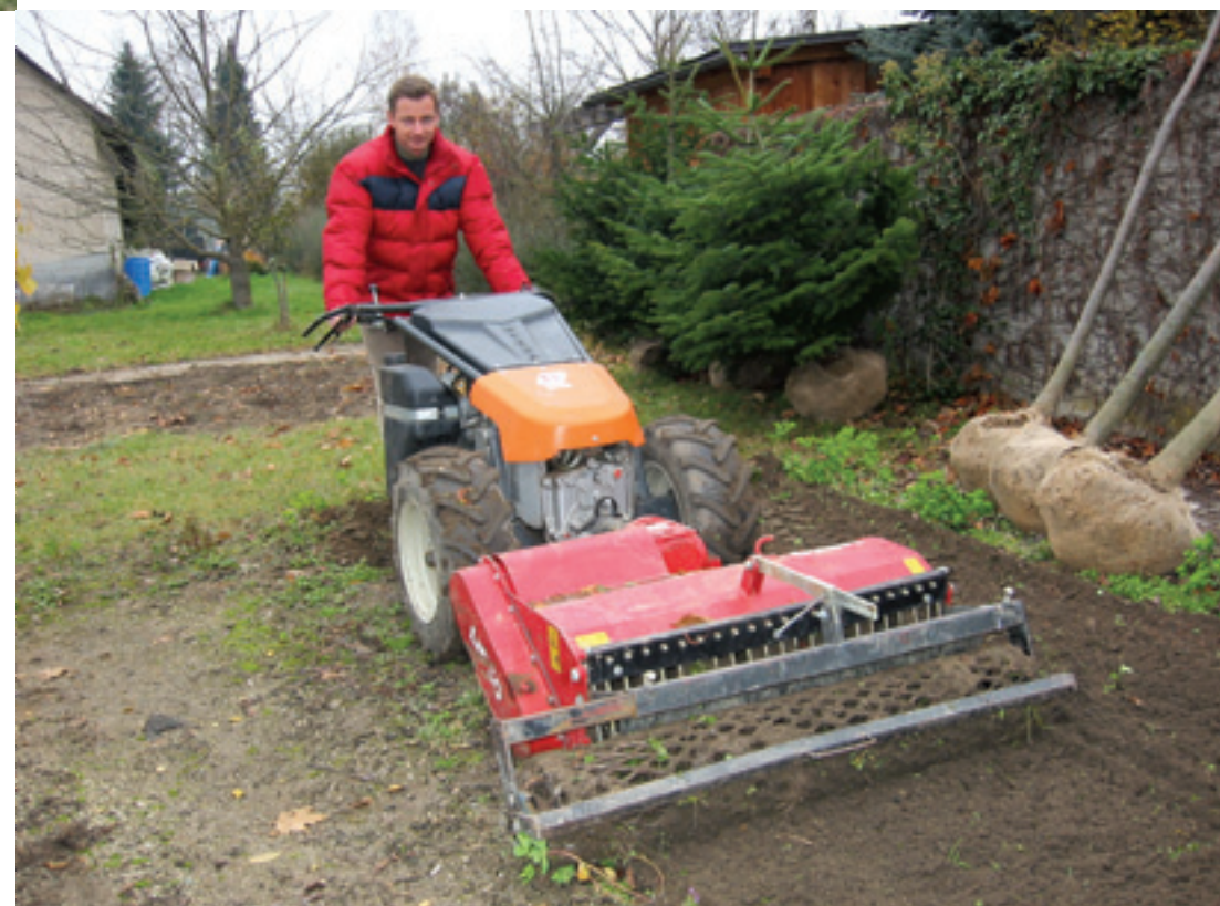
Werken met een eenasser wordt met de huidige machines een probleem volgens de nieuwe EU-richtlijn Trillingen. Je zou er nog geen uur per dag mee mogen werken.
