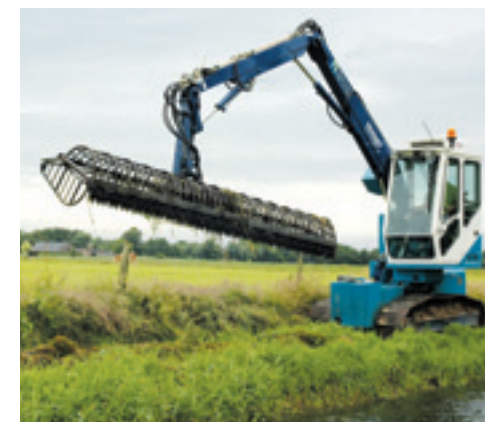
De Hooby LC 80 werkt met een 4 meter maaikorf en heeft een bereik van 7,50 m. Door een speciale draaiconstructie kan de maaikorf in de lengte van het pad lossen. Bij voorkeur wordt er achter de machine gelost waardoor de rupsen niet door het maaisel hoeven te rijden.
