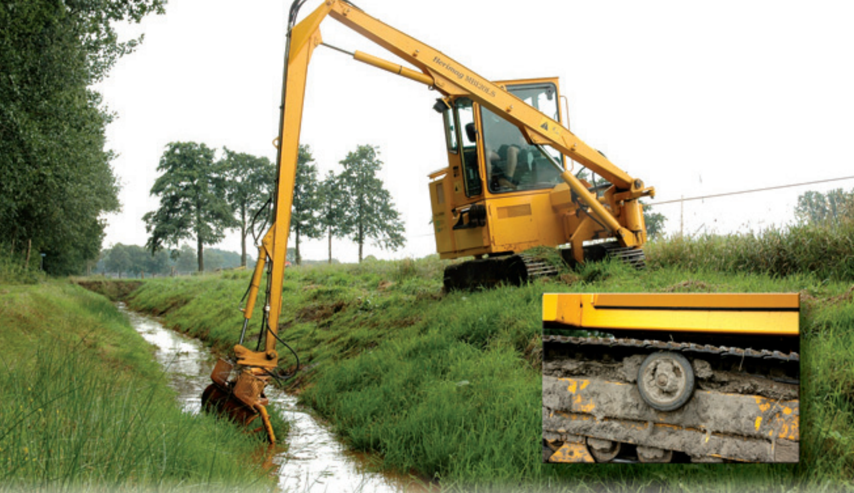
De Herimag is de eerste machine die speciaal is gebouwd voor maaikorven op de rand van de sloot vanaf een smal schouwpad. Inzet: Een van de verbeteringen van de Herimag zijn details aan de rupsen om de slijtage te verminderen. Extra steunrollen bleken de oplossing voor problemen met een onstabiele gang van de machine.
