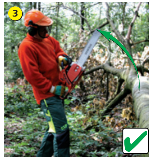
10x grotere massa weerstand en 4x grotere hefboom tegen kick-back.
