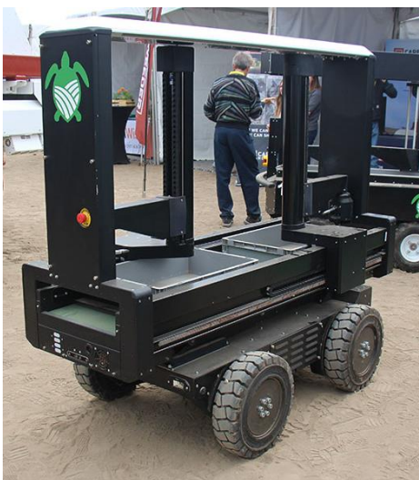
Figuur 11 : De Tortuga robot voor rijden en aardbeien
