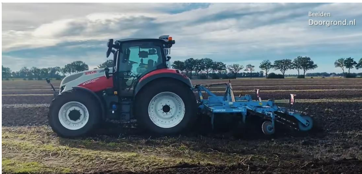
Figuur 13 : De autonome Steyr voerde succesvol een grondbewerking uit bij een NPPL-teler, er zit niemand in de cabine. (Bron: Doorgrond.nl, Nationale Proeftuin Precisielandbouw)
