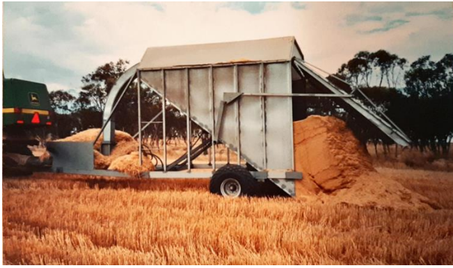
Figuur 17 : kaf verzameling systeem in Australië. Deze is getrokken achter de maaidorser en is op de foto kaf aan het lossen op de kopakker.
