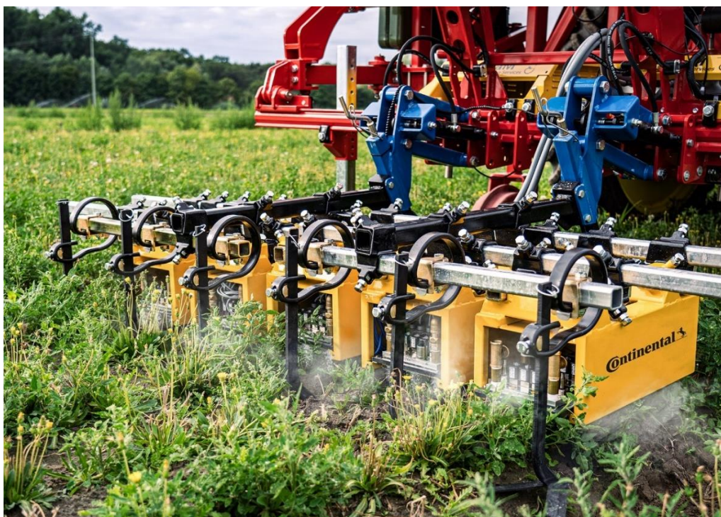
Figuur 5 : Het Weed Control System van Continental spuit kokend water op het onkruid (Bron: Continental press release)
