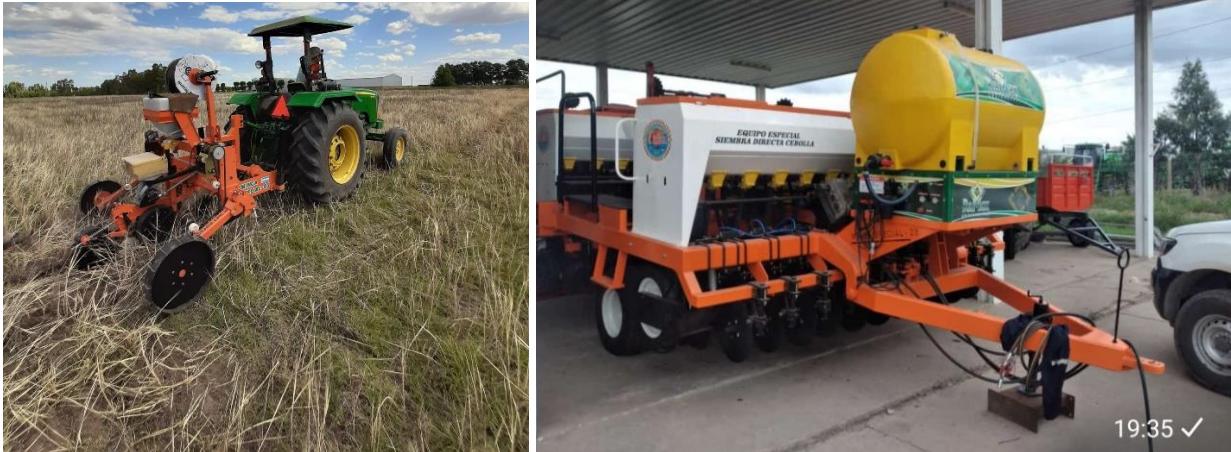
Figuur 19 : Argentijnse vastegronddaaimachines voor uien. Links: kleine machine die in dezelfde werkgang druppelirrigatieslangen en vaste kunstmest aanbrengt. Rechts: brede machine die direct vloeibare kunstmest injecteert (Met dank aan: Juan Pablo D'Amico, INTA)
