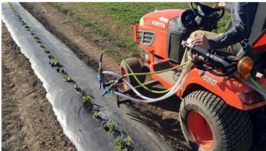
Figuur 6 : De 'abrasive weeding' machine in een testopstelling in de VS
