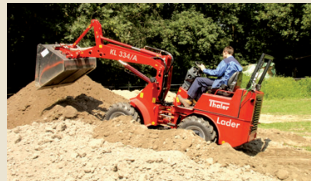
Een kniklader, of minishovel, is erg wendbaar en voor meer werk dan zand scheppen in te zetten.
