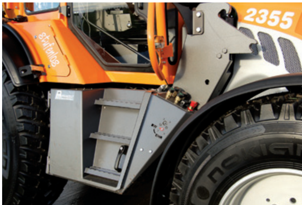
Om het bestaande frame maakt Pfanzelt een extra sterk frame met geïntegreerde console voor een voorlader. In de trap zit aan beide kanten een deurtje voor onderhoud aan bijvoorbeeld de accu's en olie voor de remmen.
