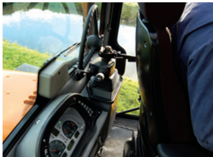
Doordat het dashboard naast de stuurkolom zit, kan de stuurkolom ver opgeklapt worden. Ook het stuur kan verder geklapt worden. Zo is er genoeg ruimte om met de stoel te draaien.
