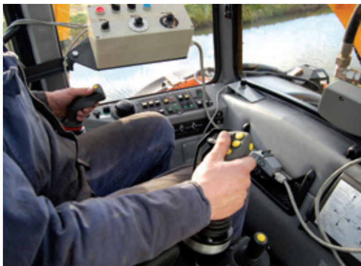
In beide armleuningen zit een geïntegreerde joystick voor elektrische besturing van de hydrauliek functies. In de rechter zit een hendeltje waarmee je de trekker achterstevoren kunt sturen.
