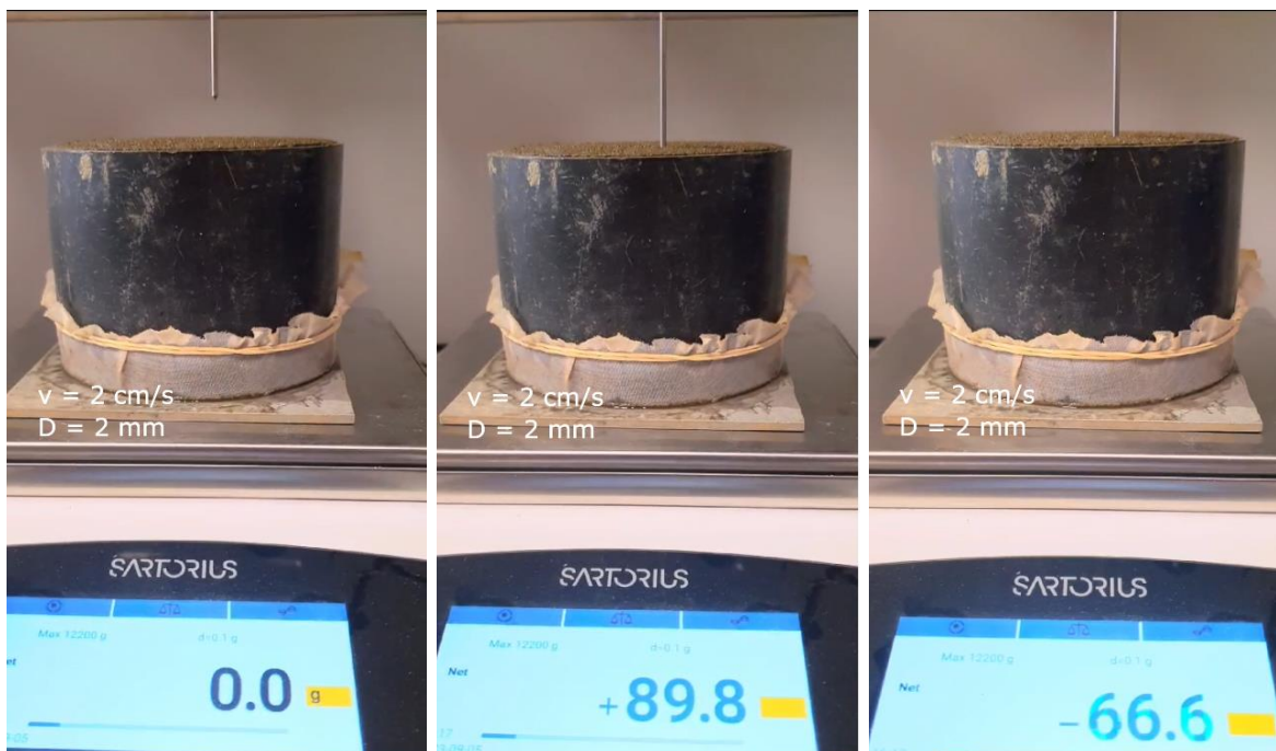
Figuur 8 Close up van de balans met monster tijdens penetratie met 1200 mm/min. Links: getarreeerde balanswaarde '0.0 gram' voorafgaand indringing; Midden: positieve balanswaarde bij neergaande beweging; Rechts: negatieve balanswaarde bij opgaande beweging.
