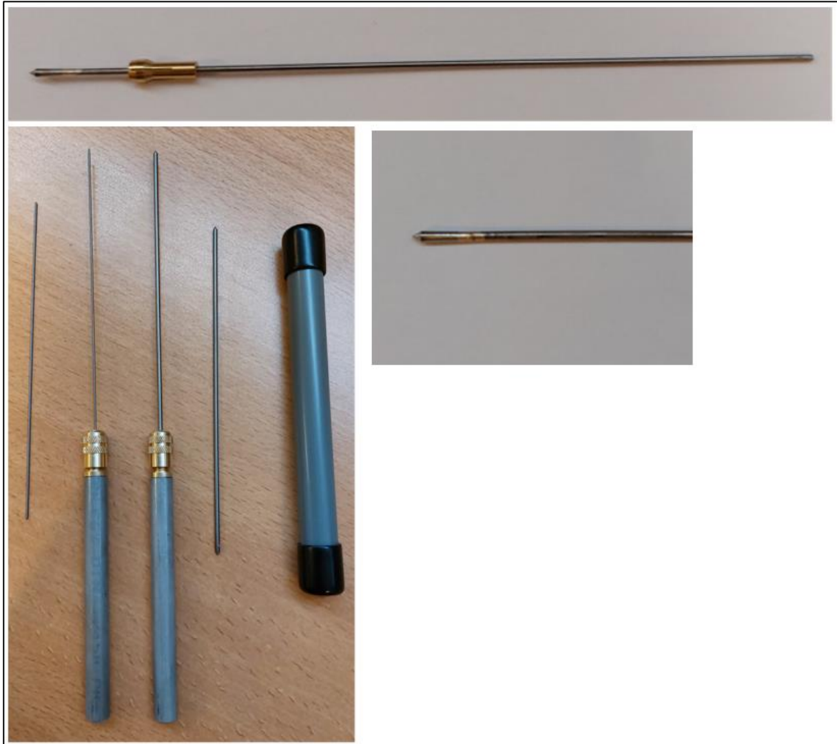
Figuur 5 Boven en rechts: Conus van één van de penetrometernaalden. De schacht heeft een doorsnede van 1.6 mm en de conus een doorsnede van 2 mm. De punt heeft een hoek van 60 graden; Links: Twee soorten rechte (wolfram) naalden zonder conus maar wel met afgeschuinde punt van 60 graden. Er zijn twee rechte naalden met een diameter van 2 mm en twee rechte naalden met een diameter van 1 mm. Alle varianten zijn gebruikt om de verschillen in indringingsweerstand te onderzoeken.
