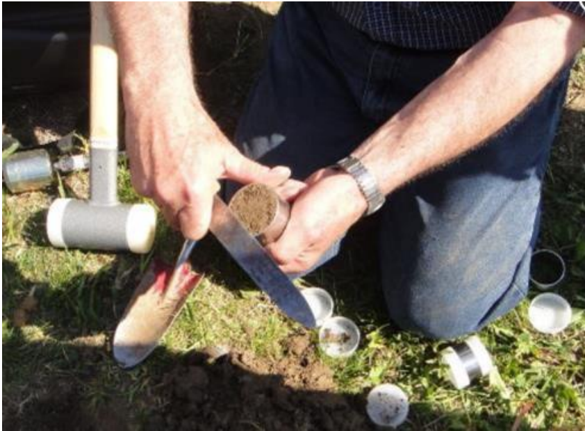
Figuur 7 Het afwerken van een 100cc ringmonster in het veld (foto: WENR).
