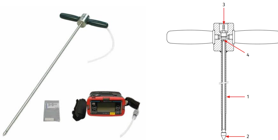
Figuur 10 De zuurstofmeter met bodemgassonde (foto en tekening: Royal Eijkelpark BV).
