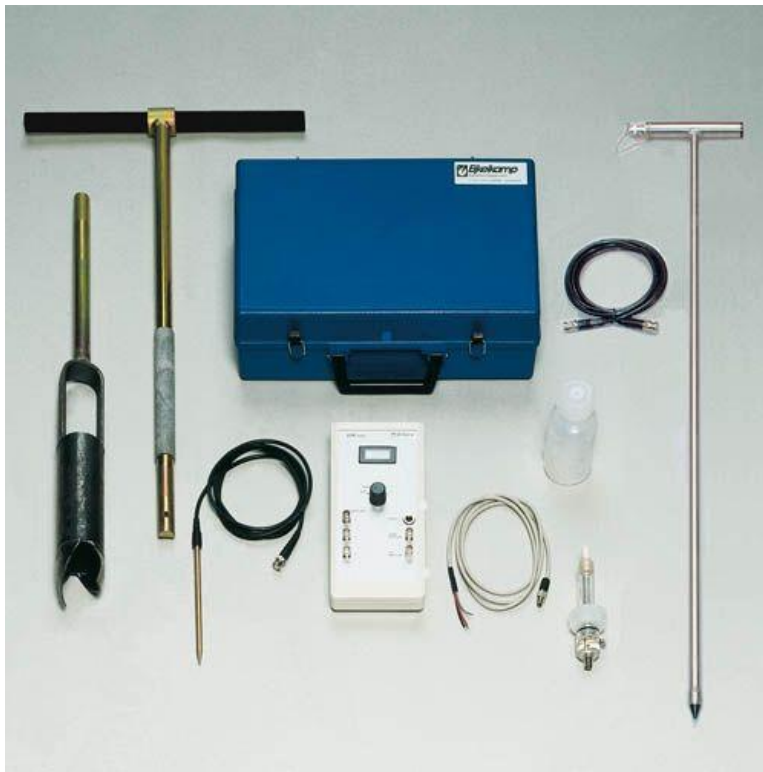
Figuur 11 De zuurstofdiffusiesnelheidsmeter meetset (foto: Royal Eijkelkamp BV).
