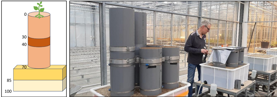
Figuur 6 Schematische weergave (links) en de werkelijke opbouw (rechts) van de 70 cm hoge kolommen van de kasproef, waarbij de bovenste 30 cm en de onderste 30 cm van de kolommen niet verdicht zijn ( \rho_d = 1350 \text{ kg m}^{-3} ) en het 10 cm hoge middengedeelte steeds een andere compressie heeft ondergaan: S1 = 100 \text{ kPa} , S2 = 200 \text{ kPa} , S3 = 300 \text{ kPa} en S4 = 400 \text{ kPa} ). Het middengedeelte van de referentiekolom heeft steeds een dichtheid die overeenkomt S0 = 1350 \text{ kg m}^{-3} , dus conform de dichtheid van de rest van de kolom. De witte bakken op de foto rechts zijn bedoeld om de onderrandvoorwaarde (vochtleverantie) voor de kolommen te regelen.
