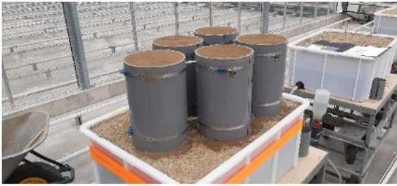
Figuur 2 Foto's van de proefopstelling in de kas (a, b; foto: Falentijn Assinck, 2023) en (c) schematische weergave van de kolommen met verdichte laag op 30-40 cm, geplaatst op grof zand (70-85 cm) op Blokzijlzand (85-100 cm).
