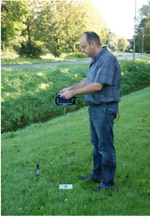
Figuur 6 De penetrologger; meetapparaat en drijfstang in gebruik in de praktijk met rechts een conus die aan het eind van de drijfstang is gemonteerd (foto's: Royal Eijkelkamp BV).
