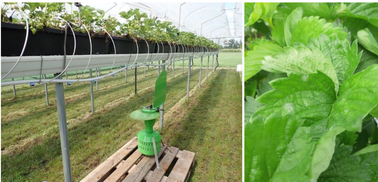
Figuur 8.5 Burkhard sporenvanger onder de stelling geplaatst (links) om meeldauw sporen (rechts) te kunnen detecteren op het moment dat ze door de wind worden verspreidt.
