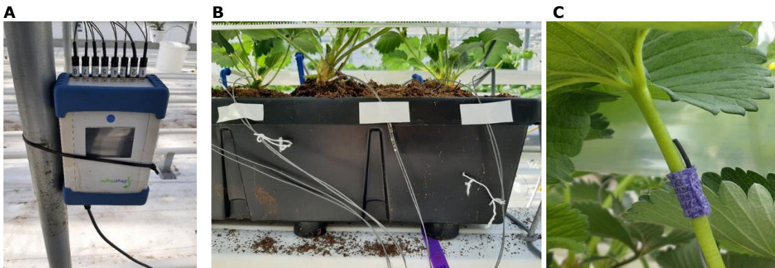
Figuur 6.1 (A) Elektrofysiologische sensor (Vivent Biosignals), (B) Elke plant was verbonden met 2 elektrodes, (C) 1 electrode werd in de bladsteel gestoken, en 1 electrode werd in het rhizoom gestoken.
