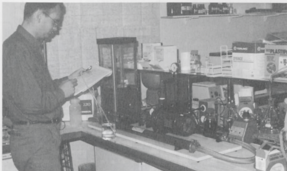
Figuur 6. Laboratoriumschaal membraanfiltratie-unit
