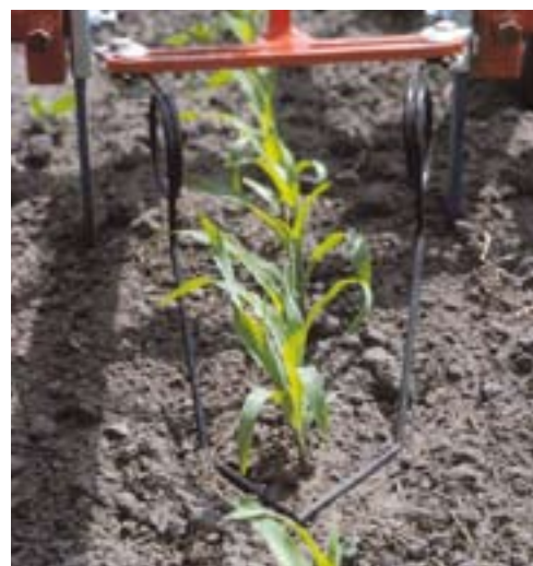
Ook de torsiewieders met 7 mm dikke tanden zijn van Frato Machine Import. Net als de vingerwieders zijn ze aan de draagbalk van de frontschoffel opgehangen.
