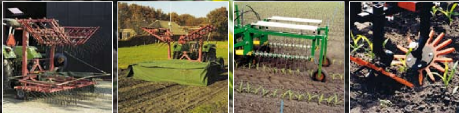
De wiedereg in de proef is Einböck met 6 rijen geveerde stalen tanden met een doorsnede van 7 mm. De afstand tussen de tanden is 15 cm. De machine heeft vier elementen van 1,5 m breed die pendelend zijn opgehangen.
