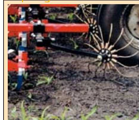
Tijdens de proef bekeken de onderzoekers een nieuwe en zelf bedachte experimentele wieder, gebaseerd op de rotorwieder van Steketee. Die werkt te agressief op zandgronden. Daarom werden voor de proef geveerde harkwielen van een oprolpers aan de machine gemonteerd. De tanden zijn 10 cm ingekort waardoor ze rechter staan. De rotorwieders werden met verende dragers aan de draagbalk van de frontschoffel gehangen.
