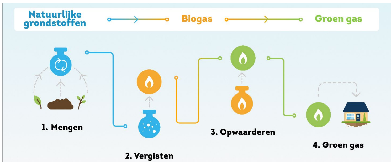
Figuur 2 Schematische weergave van de productie van groengas (Powerpeers, 2024).
